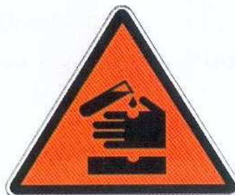
sostanze corrosive o irritanti
